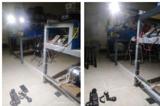
Gambar 7. Pengujian Luminasi lampu COB (30x2) watt dan COB 50 watt
