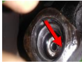
Gambar 6. Lubang delivery valve terdapat partikel.
